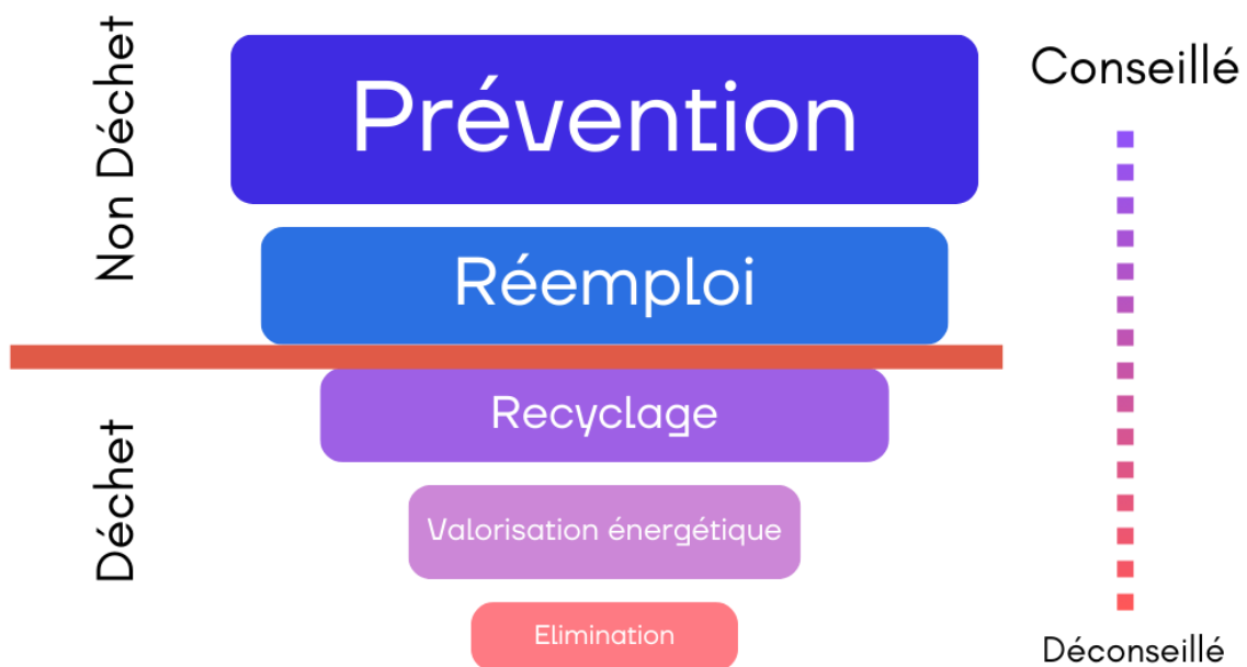
Figure 1 : Hiérarchie de la prévention et des modes de traitement des déchets (Directive 2008/98/CE) Source : ministère de l'Aménagement du Territoire Transition Ecologique reproduit et adapté
